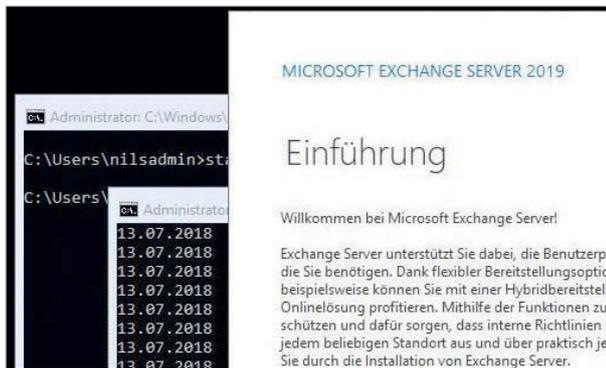
**Exchange 2019 lässt sich erstmals auch in der Core-Variante des Serverbetriebssystems installieren. Das erhöht die Sicherheit und reduziert die Zahl der System-Updates (Abb. 2).**
